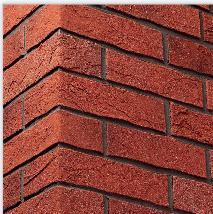
Elastyczne płytki elewacyjne IZOFLEX, Wzór: Stara Cegła. Wykończenie: 2 kolory. Materiał: na bazie żywicy syntetycznej. Montaż: na kleju IZOFLEX-SK. Wymiary [mm]: dł./szer. – 240/(52, 65, 71), 360/(52, 65, 71), grubość – 3.
